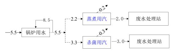
图 3.5-1 拟建项目蒸汽平衡图 (m³/d)
