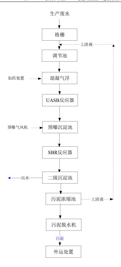
图 8.1-1 废水处理站工艺流程图
