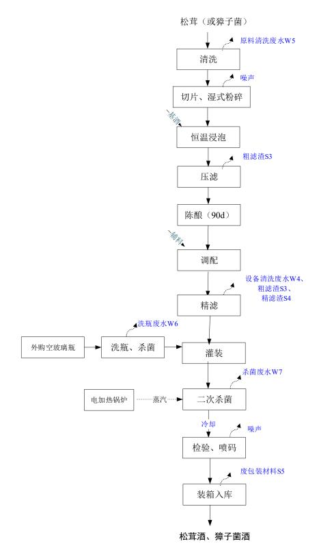
图 3.2-2 配制酒生产工艺流程
