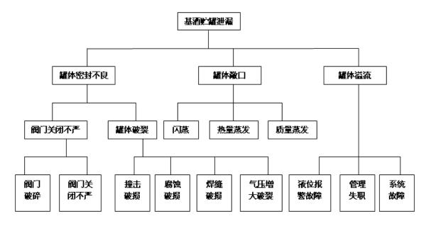
图 7.3-1 基酒储罐发生泄漏事故树
