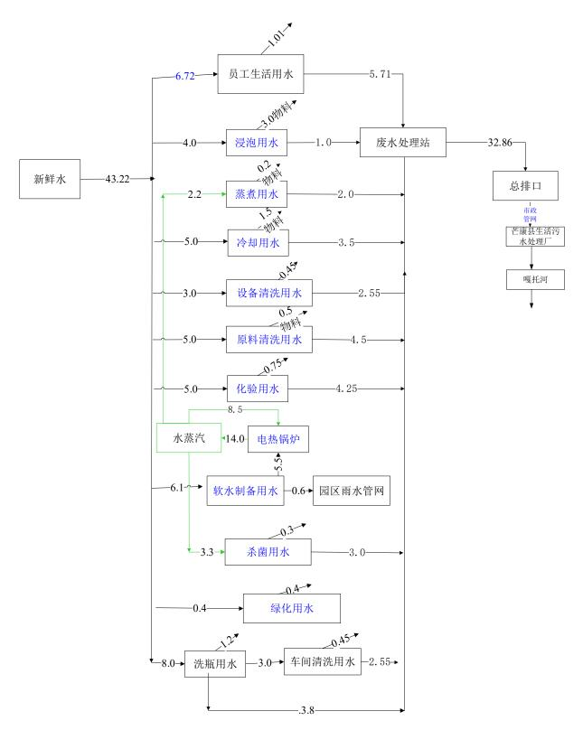
图 3.4-1 拟建项目水平衡图(m³/d)
