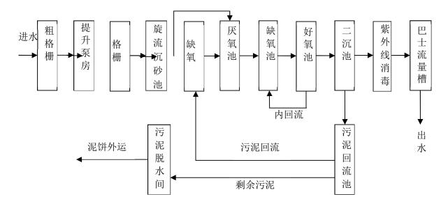
图 8.1-2 污水处理厂改良 A/A/O 工艺流程图
